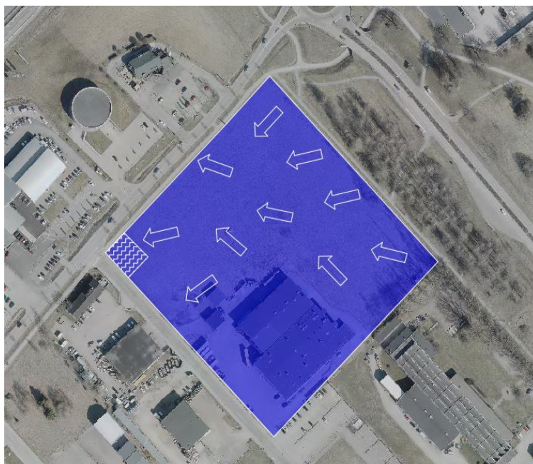
Pilarna visar förslag på riktningar hur marken ska lutas för att dagvattnet ska rinna mot dagvattendammen.
